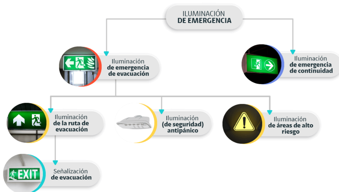
Figura 3.2.4. a. Formas específicas de iluminación de emergencia (Adaptado de NTC 6556)
